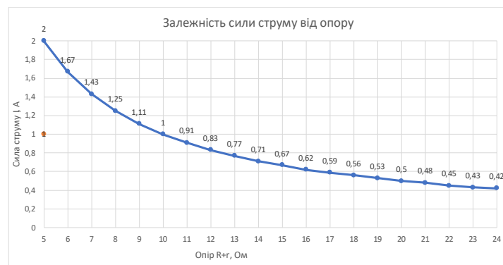
Рис. 2. Залежність сили струму від опору в колі постійного струму
