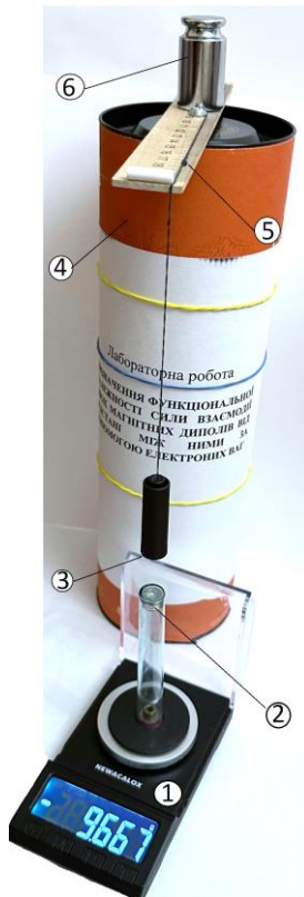
Рис. 1. Фото дослідницької установки: 1 – електронні терези, 2 – магніт №1, 3 – магніт №2, 4 – паперовий тубус, дерев'яна лінійка міліметрова, 5 – вузол на нитці, 6 – тягарець
