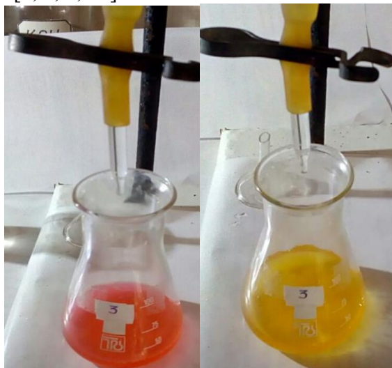
Рис. 3. Розчини зі зразками зубних паст до та після титрування.
