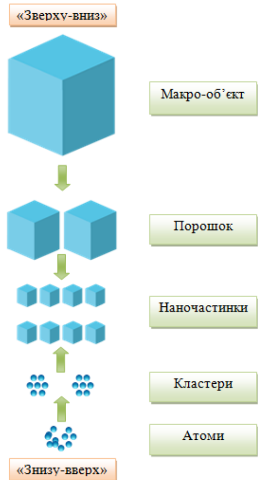
Рис. 8. Схема отримання наночастинок «зверху-вниз» та «знизу-вверх»
